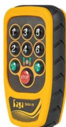
O sistema de Rádio Controle Remoto é utilizado para garantir melhor eficiência e segurança na movimentação de carga.
