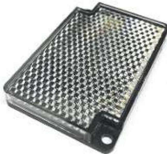
**O espelho prismático para sensor retro reflexivo permite maiores distâncias de detecção, independentemente da cor do item, sendo que a luz emitida para o espelho prismático é polarizada e refletida, e assim retorna para o sensor. Quando o objeto intercepta a luz, inibe a reflexão do espelho. A polarização feita pelo espelho prismático, assegura que o receptor do sensor detecte somente a luz emitida.**
