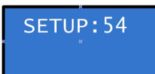
O ajuste do alarme para o relé 2 será baseado no alarme do relé 1, o valor a ser programado será a diferença do ângulo de atuação do relé 1 para relé 2, por exemplo:
