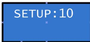
Este parâmetro calibra o ponto zero, ou a posição de repouso do cabo, o equipamento já vem calibrado para o ângulo zero, porém a fixação do equipamento no cabo ou até pequenas inclinações de cabo podem facilmente deixar o equipamento desalinhado.
