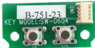
Circuito start saga1-L8B-L10 para chave start
